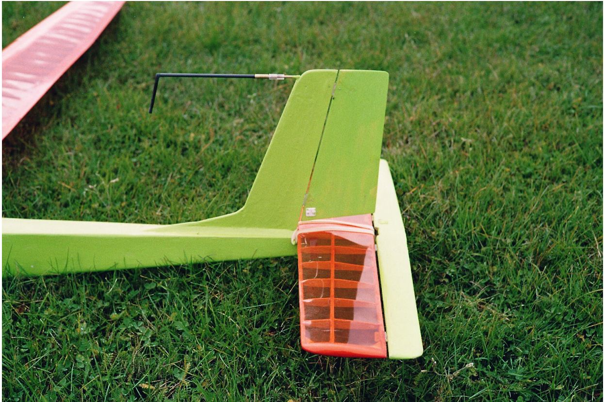
Bild 3 Das Messingrohr für die Druckabnahmenstelle wird bei einem Zweiachssegler in den Nasenbereich des Seitenleitwerks einlaminieren, wie hier beim MOSQUITO von Graupner (2,5 m Spannweite) zu sehen ist
