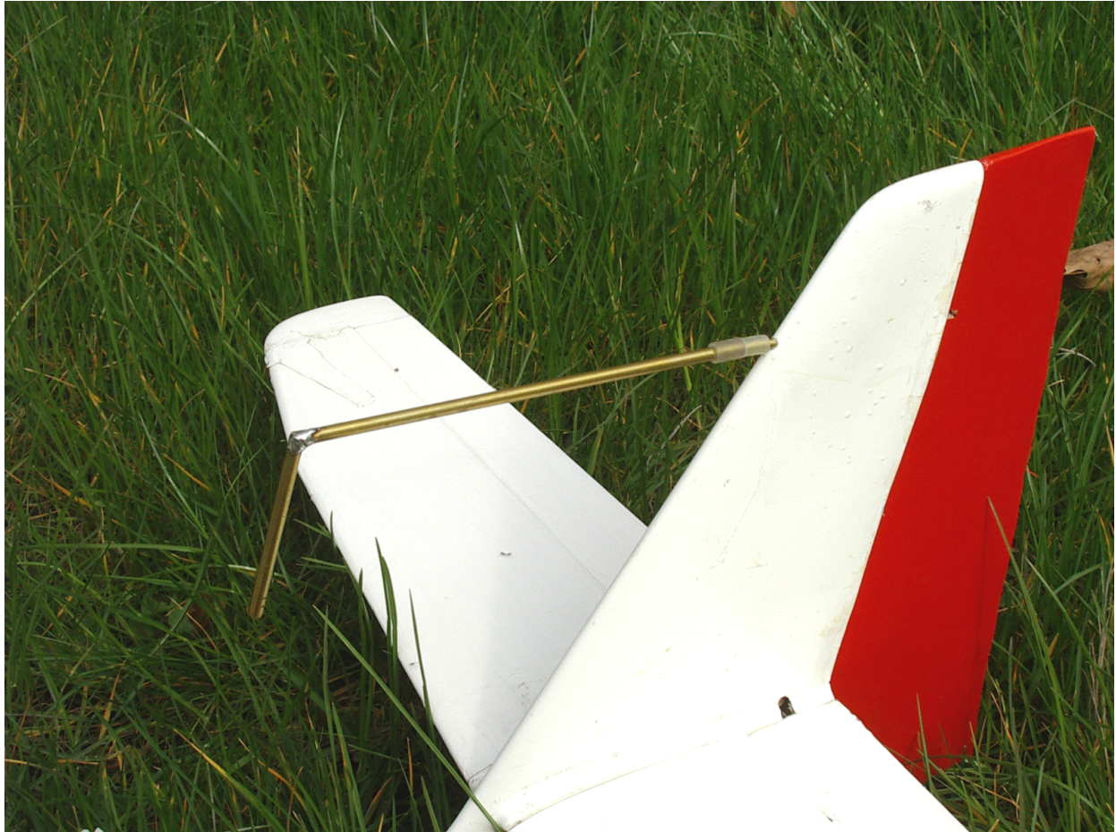
Bild 4 Vorderansicht der Anbringung am Seitenleitwerk des Elektroseglers CANDIDA von Graupner (3,6 m Spannweite). Das Aufsteckrohr mit dem Außendurchmesser von 3 mm ist im Seitenleitwerk in einen Balsaholzklötzchen eingelassen und daher auch gegen unerwünschte Stöße beim Handling des Modells gerüstet
