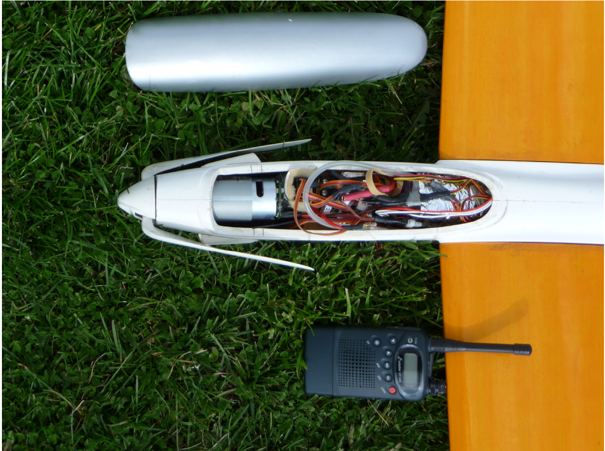
Bild 8 Mit Vario und Düsenanschluss herrscht im Rumpf der ORBITA ein echtes Gedränge
