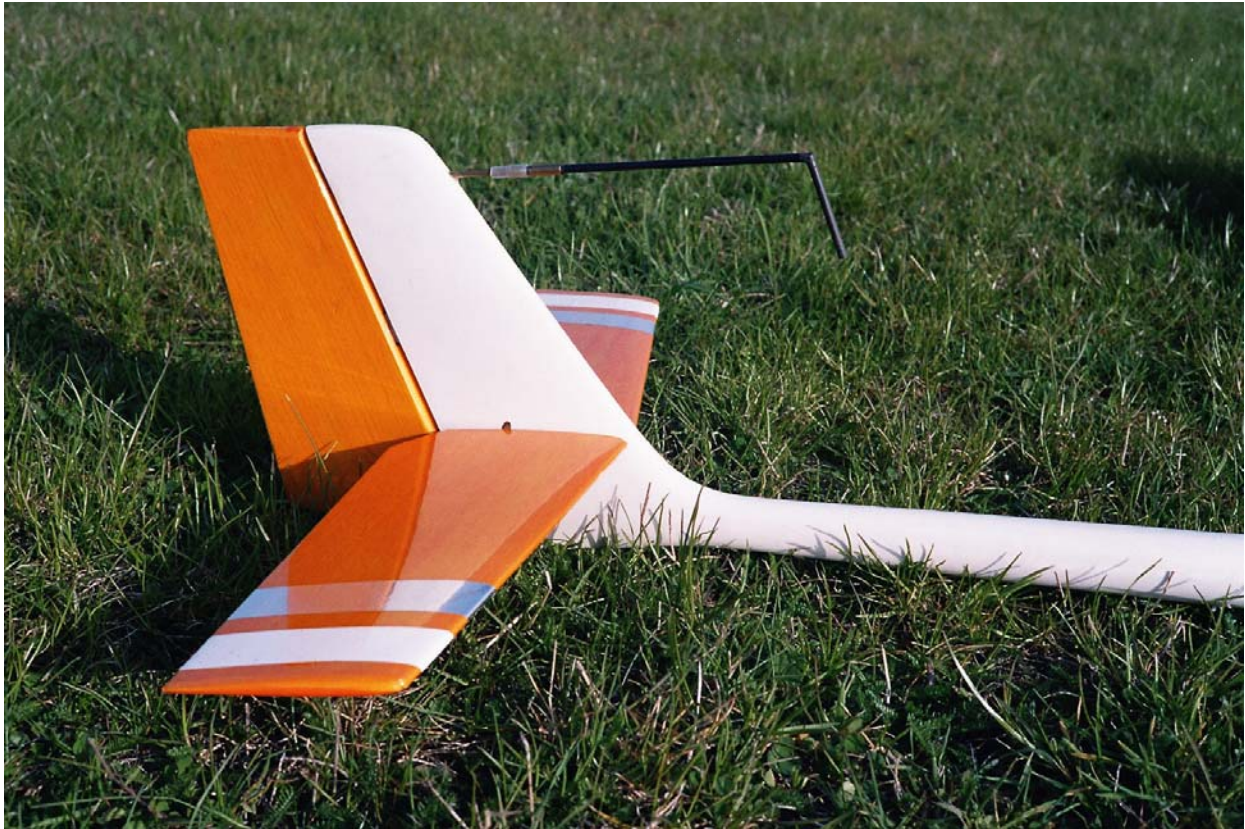
Bild 6 Auch bei der ORBITA von Beineke Modellbau (2,4 m Spannweite) wurde im Seitenleitwerk eine Druckabnahmestelle eingearzt, die dann mit einem dünnen Schlauch nach vorne verbunden ist. Die Karbondüse wird zur Durchmesseranpassung mit einem gelöteten Messingadapter versehen, der wiederum mit einem Silikonschlauch abgedichtet werden muss
