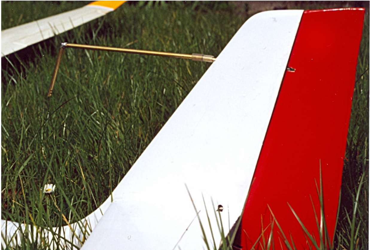
Bild 5 Zur Abdichtung wird die Aufschubstelle mit einem Silikonschlauch überzogen, wofür sich Kraftstoffschlauch bestens eignet. Gut sichtbar ist hier auch der nach hinten geöffnete Doppelschlitz der Kompensationsdüse
