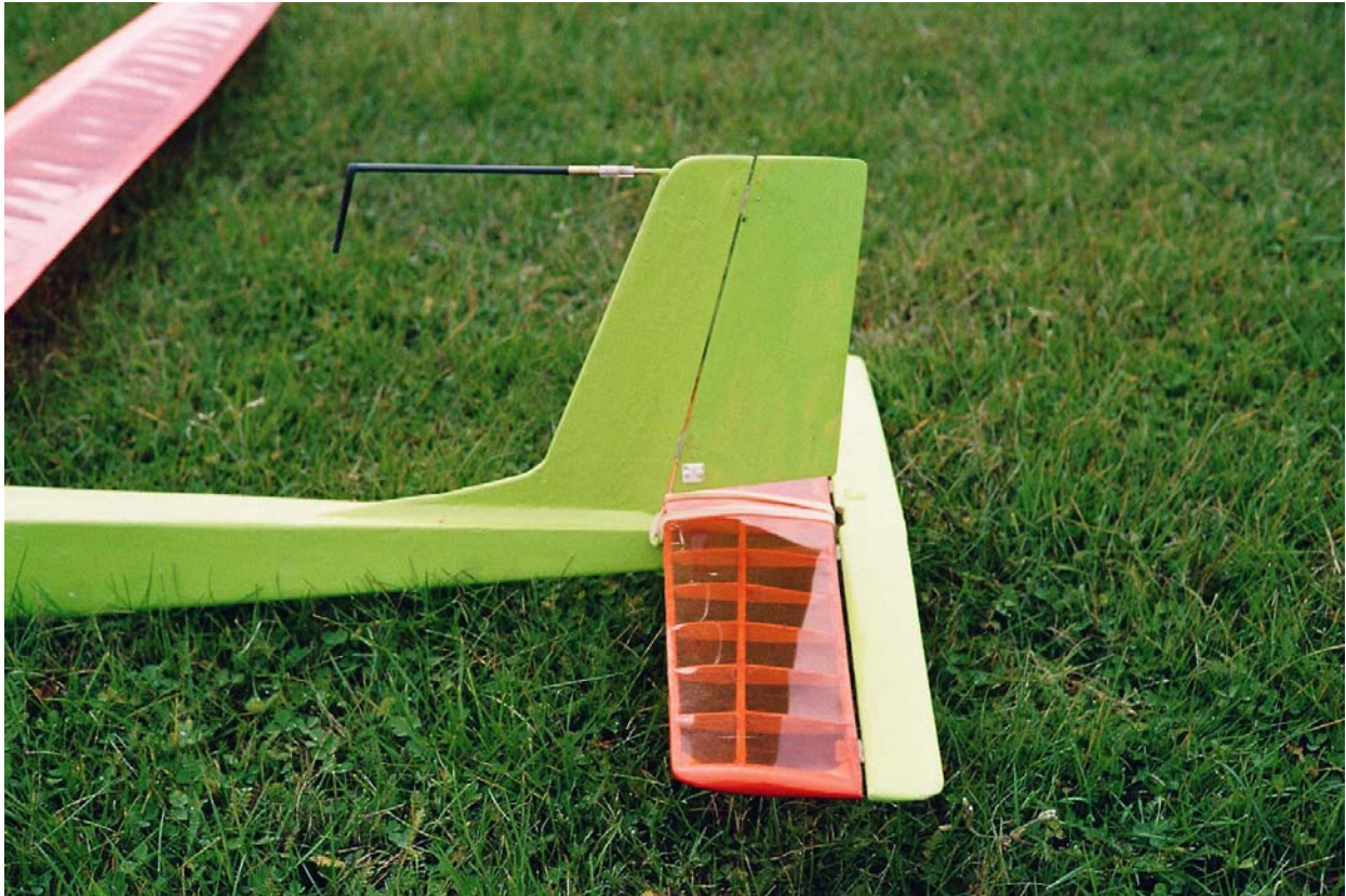
Bild 3 Das Messingrohr für die Druckabnahmenstelle wird bei einem Zweiachssegler in den Nasenbereich des Seitenleitwerks einlamiert, wie hier beim MOSQUITO von Graupner (2,5 m Spannweite) zu sehen ist
