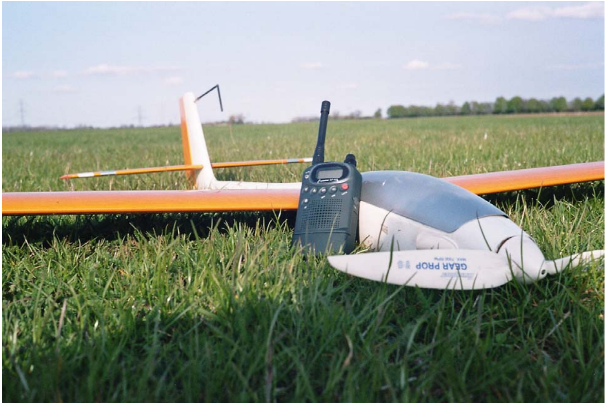
Bild 7 Die ORBITA von Beineke Modellbau (2,4 m Spannweite) mit Kompensationsdüse aus Karbon zusammen mit einem UHF-Walkitalki (433 MHz)
